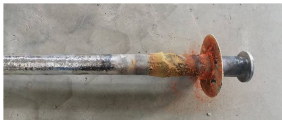
图 1 搅拌桨杆上的挥发物
