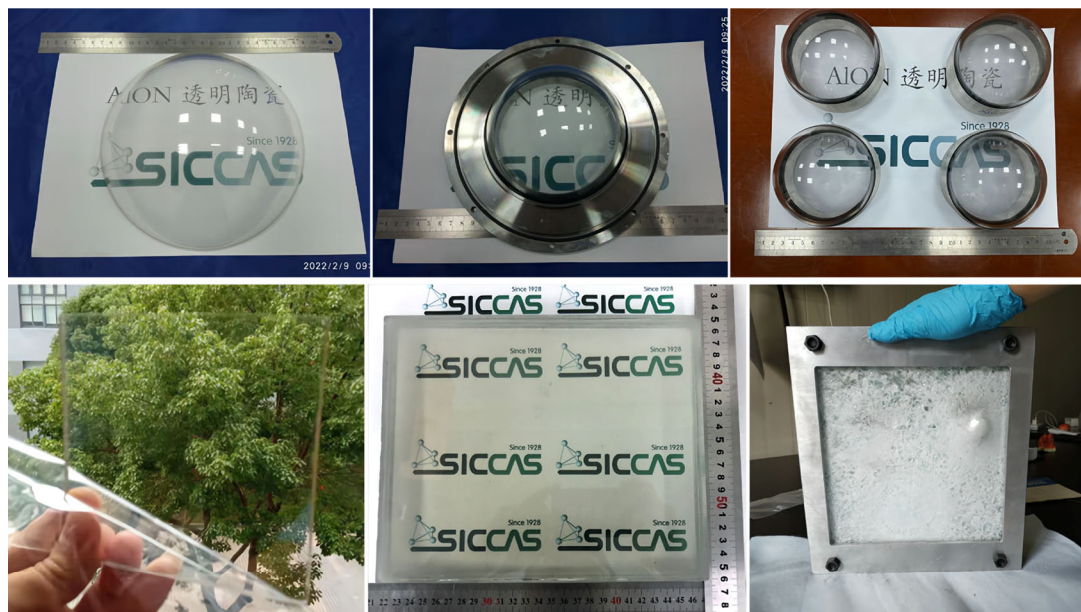
图 5 上海硅酸盐研究所在氮氧化铝陶瓷制备上的研究进展 [50]
