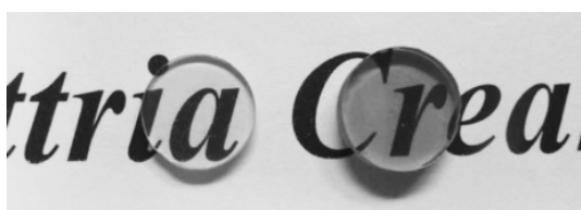
图 8 \text{La}_2\text{O}_3 掺杂制备的 \text{Yb}:\text{Y}_2\text{O}_3 (左)和 \text{Nd}:\text{Y}_2\text{O}_3 (右)透明陶瓷 [66]
