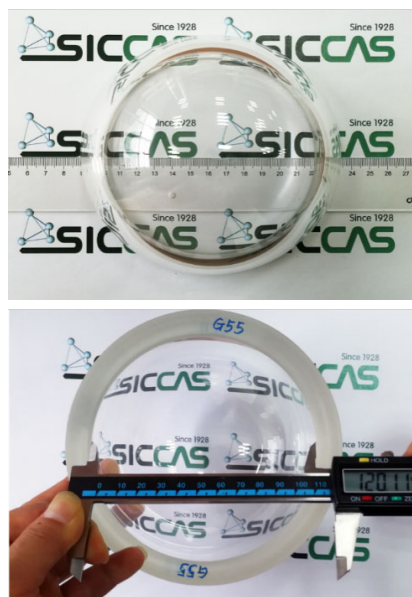
图6 工艺优化后制备的高质量的大尺寸YAG透明陶瓷球罩 Fig. 6 Photos of the large-size YAG transparent ceramic dome
