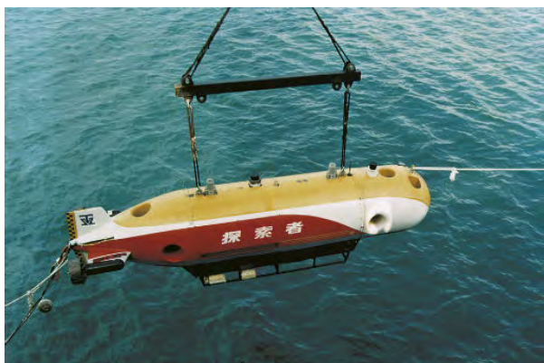
图 1 搭载铅酸电池的“探索者”号无缆水下机器人 [26]
