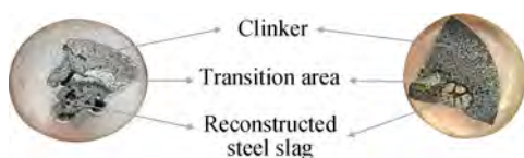
图 2 钢渣分相熟料的岩相光片
