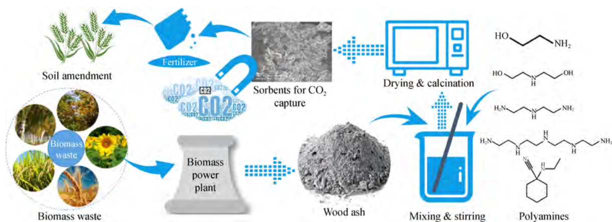
图 3 生物质灰作基体材料负载有机胺制备固态胺吸附剂示意图 [51]
