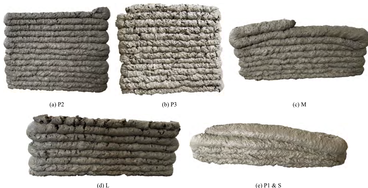
图 6 4 种建造性倒塌或失效形态
