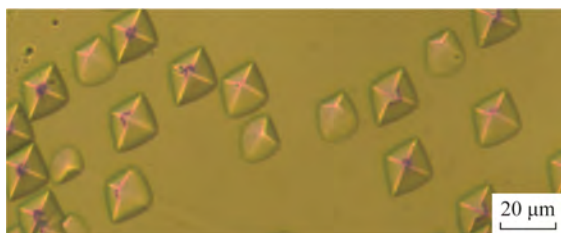
图 10 YAG 晶体(110)面腐蚀坑 Fig. 10 Etch pits of (110) of YAG crystal
