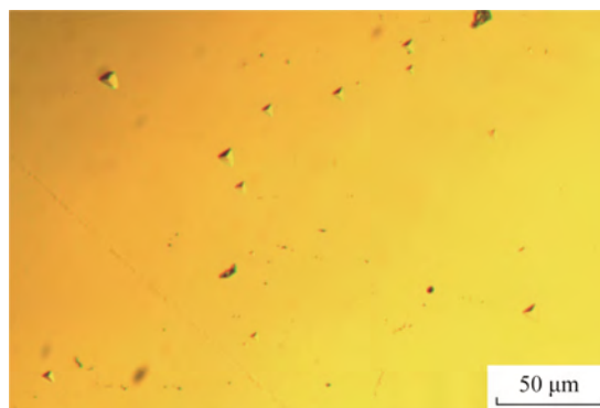
图 7 YAG 晶体(111)面位错蚀坑整体形貌特征 Fig. 7 Etch pits morphology of (111) surface of YAG crystal
