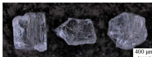
图 1 镁砂颗粒形貌及显微结构照片 Fig. 1 Morphology of magnesia particles
