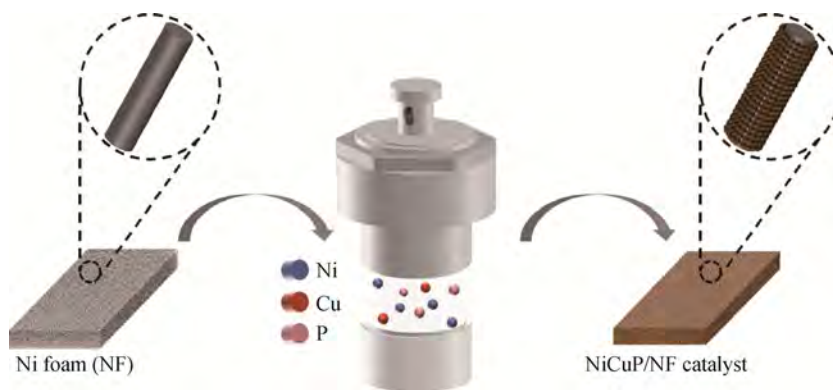
图 1 制备 NiCuP/NF 催化剂的一步法示意图
