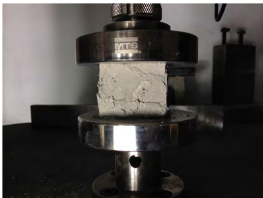
图 6 FR-ECC 立方体受压破坏形态
