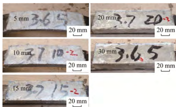
图 10 卸载后 FR-ECC 涂层破坏形态
