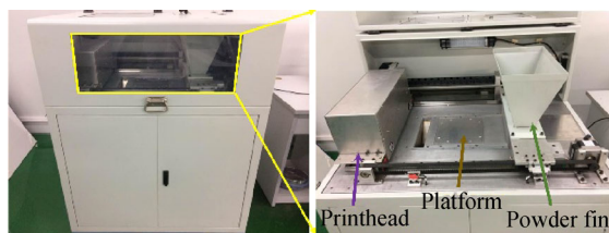
图 4 自主研发的微喷射黏结增材制造设备
