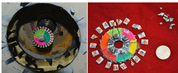
图 9 SWS-SiC/SiC 涡轮叶盘破裂前后状态
