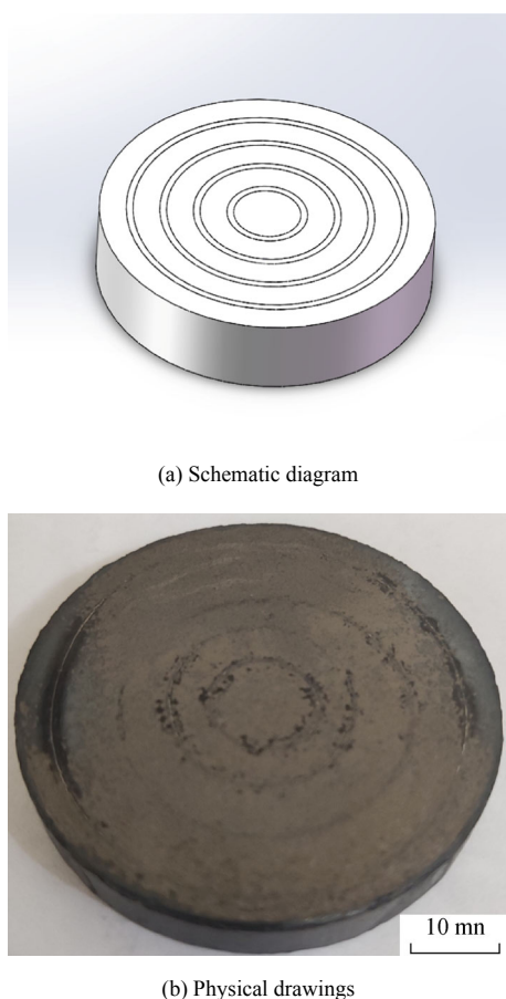
图 2 仿木年轮结构复合材料样品
