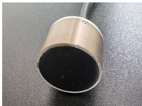
图 6 基于 1-3 型压电单晶复合材料的高频发射换能器 PIMNTC-1-T 实物图
