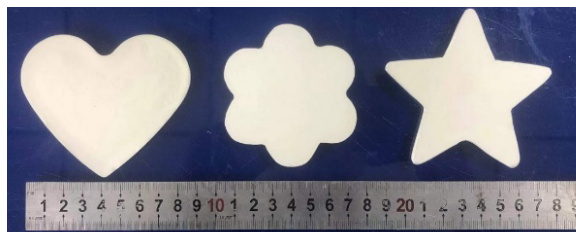
图7 较大尺寸的多孔莫来石陶瓷
