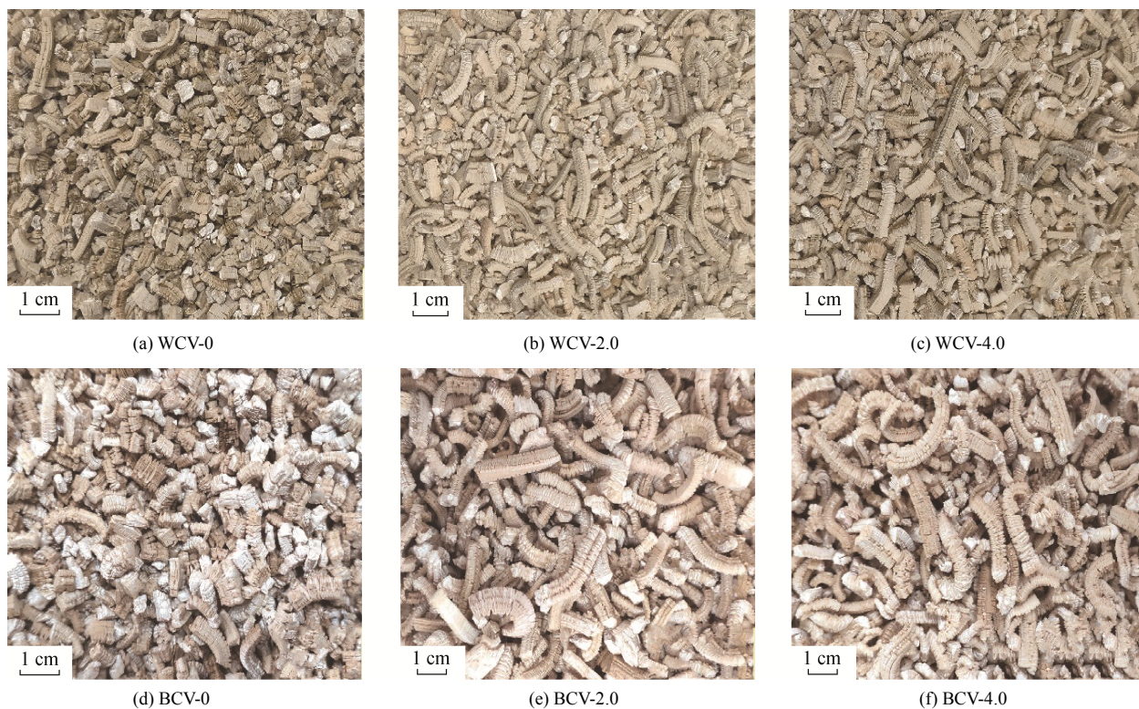
图 2 微波和焙烧加热法制备的膨胀蛭石外观形貌
