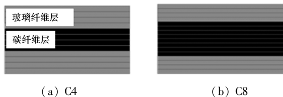
图 5 碳/玻混杂复合材料构型示意图
