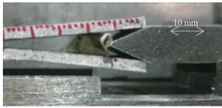
图 4 尖锐分层损伤端部的预制
