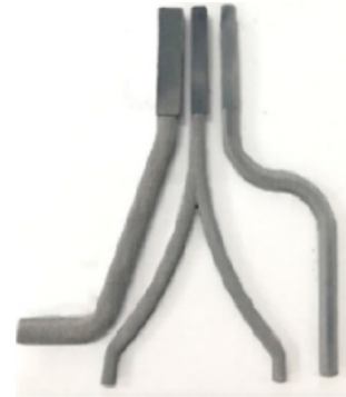
图8 粘结剂喷射成型的复杂形状氧化铝陶瓷芯胚体
