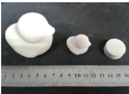
图6 选择性激光烧结制备的陶瓷样品
