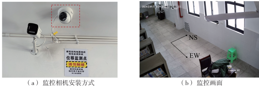
图 2 监控相机安装方式与画面展示
