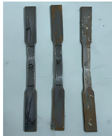
图 3 钢材断裂试样
