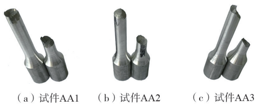
图 3 单调拉伸试件破坏形态
