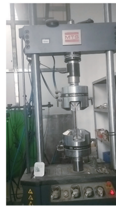
图 11 SMA 棒拉伸试验
