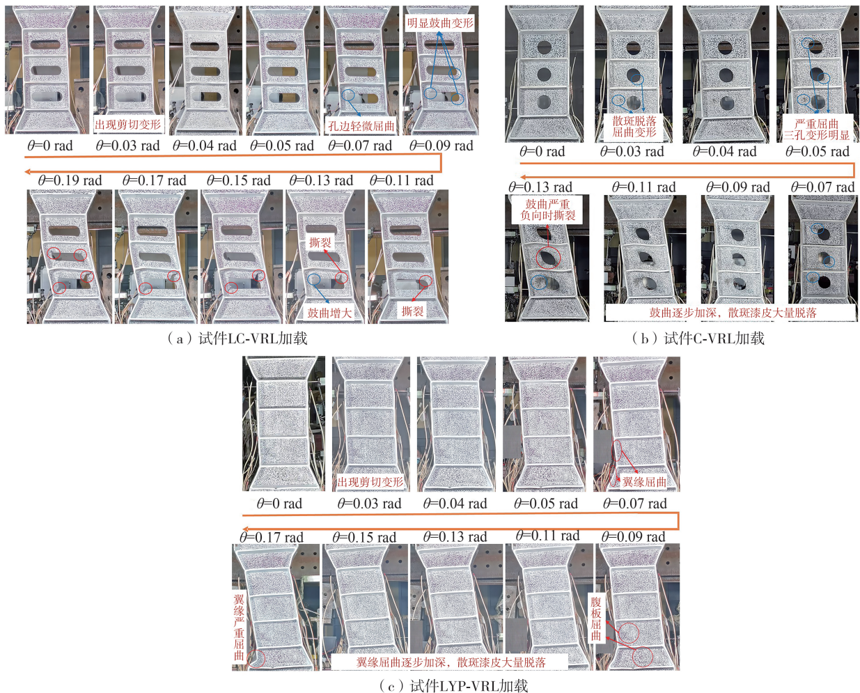
图5 试件加载过程变形图
