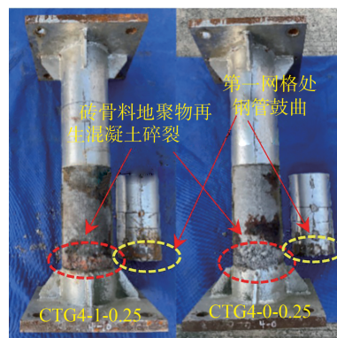
图 5 核心再生混凝土破坏模式 Fig. 5 Damage modes of inner recycled concrete
