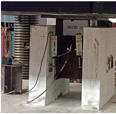
图 5 推出试验加载装置
