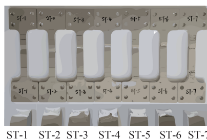
图 4 6061-T4 铝合金试件在单向拉伸作用下的试验破坏现象
