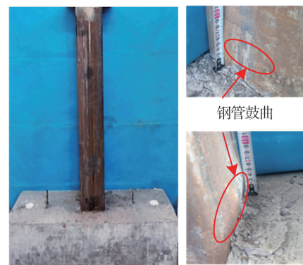
图4 试件 HU-T8-N15-L2 破坏形态
