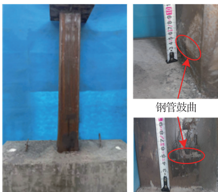
图3 试件 HU-T6-N20-L1 破坏形态
