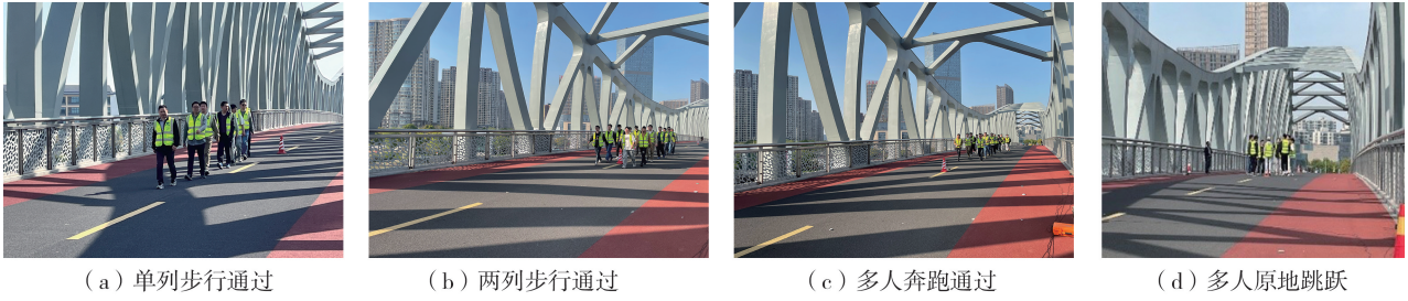
图 15 人致振动工况实测现场
