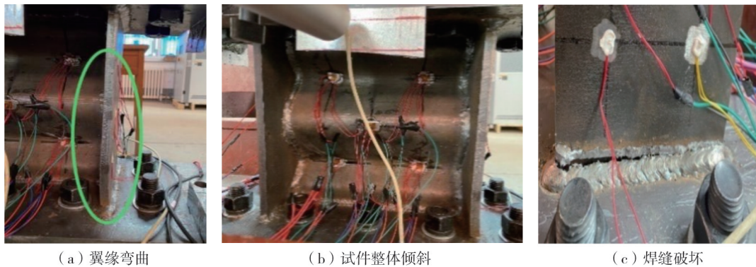
图 8 试件 SCSPD-1 的破坏形态
