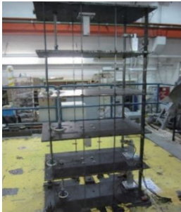
图 4 5 层框架结构振动台试验
