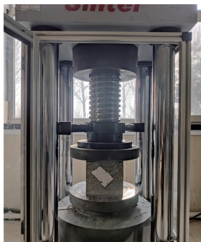
图 5 混凝土抗压强度测试
