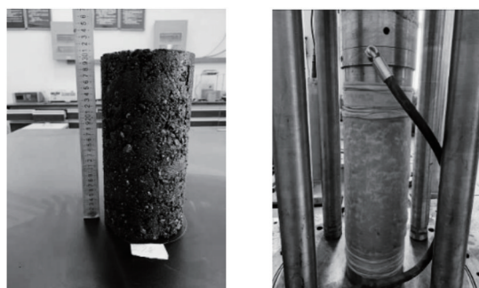
图 3 成型后的高聚物胶凝戈壁土试样
