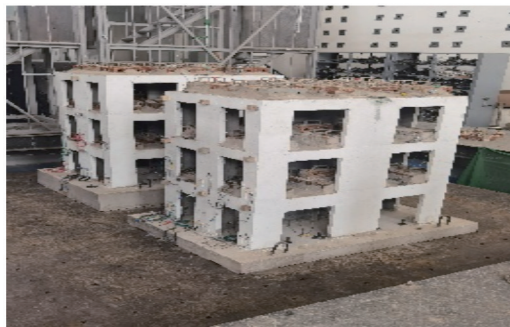
图2 振动台试验上部结构试验模型
