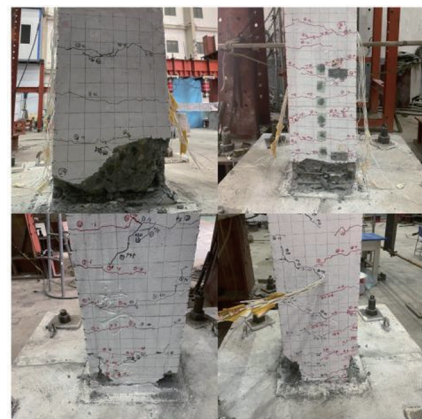
图 4 装配式试件破坏现象
