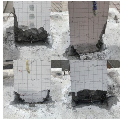
图 3 整体式试件破坏现象
