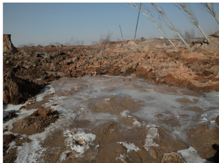
(a) 流滑区上游成片液化喷冒孔
