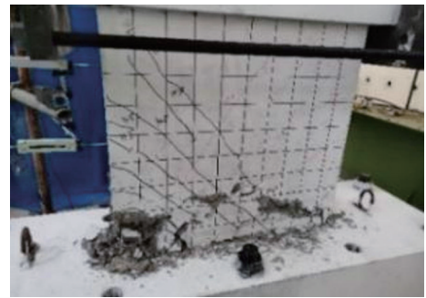
图 6 试件 SW 破坏状态
