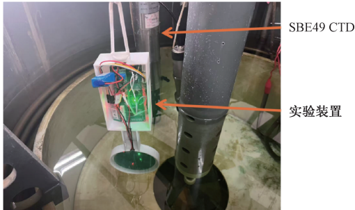
图 7 温控水槽试验过程
