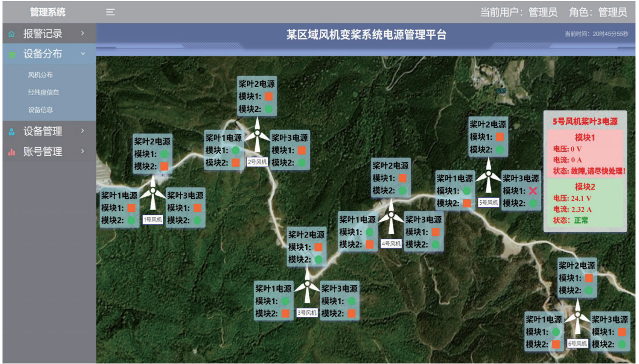
图 19 风机变桨系统电源监控平台
