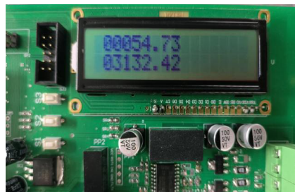
图 7 LCD1602 显示的结温和寿命次数
