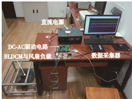
图 6 BLDCM 驱动系统故障检测实验平台
