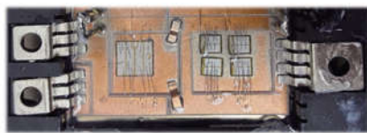
图 4 采用大芯片的高功率密度 SiC 功率模块实物 Fig. 4 Prototype of high power density SiC power module with large chips
