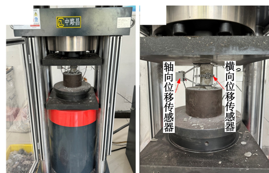
图 4 试验设备 (a) YAM-2000微机伺服压力试验机 (b) 位移传感器
