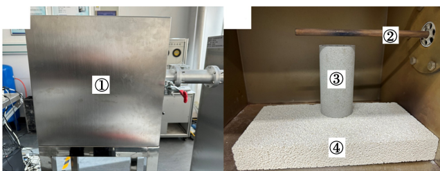
图 3 CM-03S 大功率微波破岩设备 注: ①微波辐射腔体; ②波导天线; ③待辐射试样; ④莫来石板
