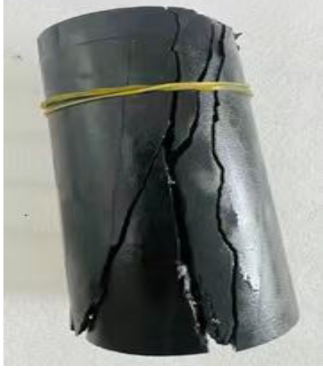
图 6 蠕变试验破坏试样
