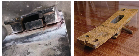
(a) 焊接滑床板
