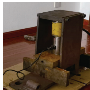
图 7 滑床板焊接部位强度测试照片
