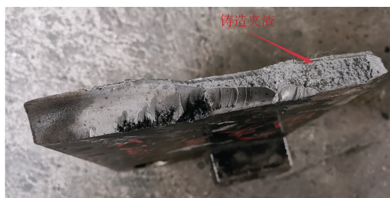
图2 生产工艺不佳导致的滑床板铸造夹渣
