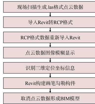
图 2 逆向建模方法的实现流程 Figure 2 Reverse modeling method
