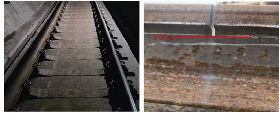
图 20 实验对象与 30% 锯轨示意
