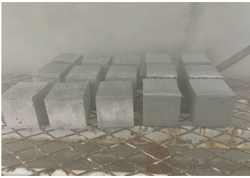
图 4 黏质渣土浆液试样
