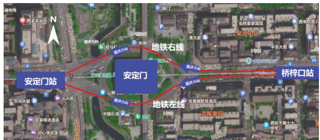
图1 地铁6号线与安定门段城墙平面
